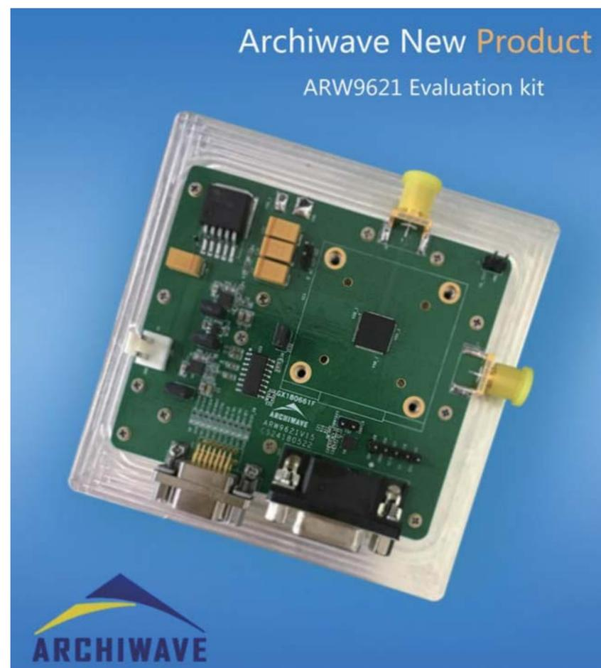
微波T/R组件是有源阵列天线的基本组成单元,在综合射频系统、5G毫米波通信和相控阵雷达领域具有广泛的应用。过去的实现方式一直停留在组件的方式,即采用多个砷化镓微波芯片,一个数字控制芯片和多个片外元器件搭建的模组,面积大,体量大,成本高。打个比方,组件搭建的相控阵天线就像老式的显像管电视,是个“胖大叔”,体积笨重;而芯片贴片式雷达就像现在的LCD电视屏,又轻又薄,是个“高富帅”。利用成本低廉的硅工艺实现单片T/R芯片,是实现系统小型化和低成本必要途径,是现代T/R组件的重要发展方向。
